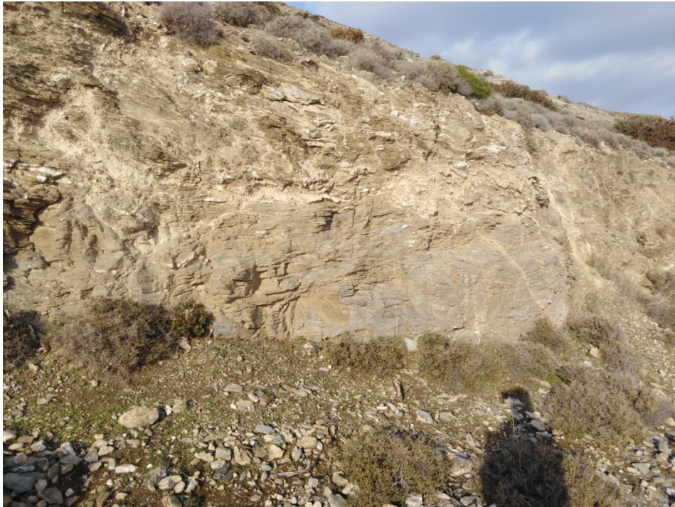
Εικόνα Φ9: Λεπτοστρωματώδεις, αποσαθρωμένοι, τεκτονισμένοι σχιστόλιθοι – φυλλίτες στο ανατολικό τμήμα.
