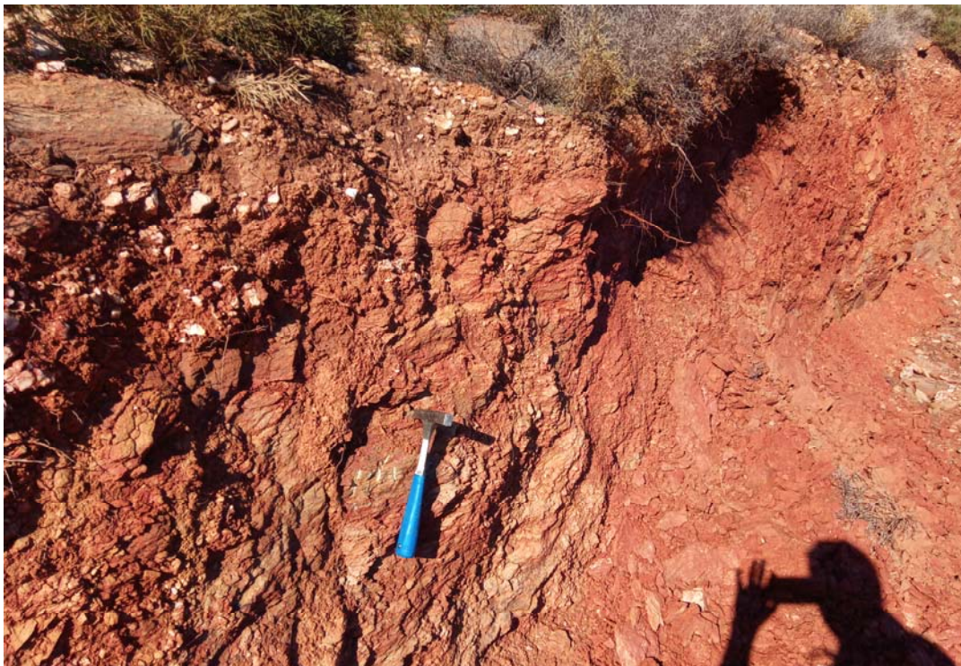
Φωτ.3.6. Μανδύας αποσάθρωσης αμφιβολιτικών σχιστολίθων με χαρακτηριστικό καστανέρυθρο χρώμα.
