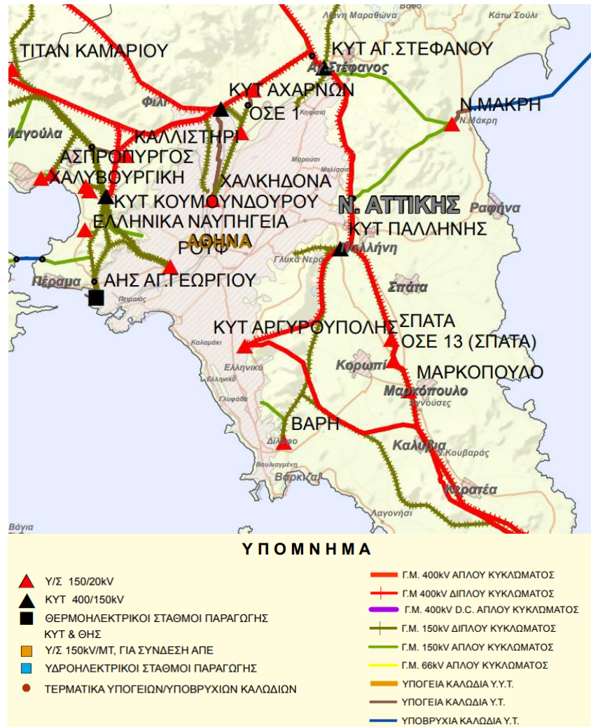
Σχήμα 6-40: Διασυνδεδεμένο σύστημα μεταφοράς ηλεκτρικής ενέργειας πρωτεύουσας
